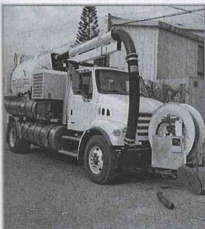
Se recuperó el camión Vector, el cual sirve para desazolver el colector de aguas negras y con esto se da mantenimiento preventivo a la red municipal y se apoya a otros municipios.
